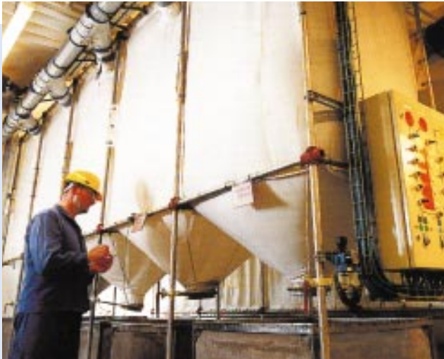
Almacenado intermedio de perlas preexpandidas
